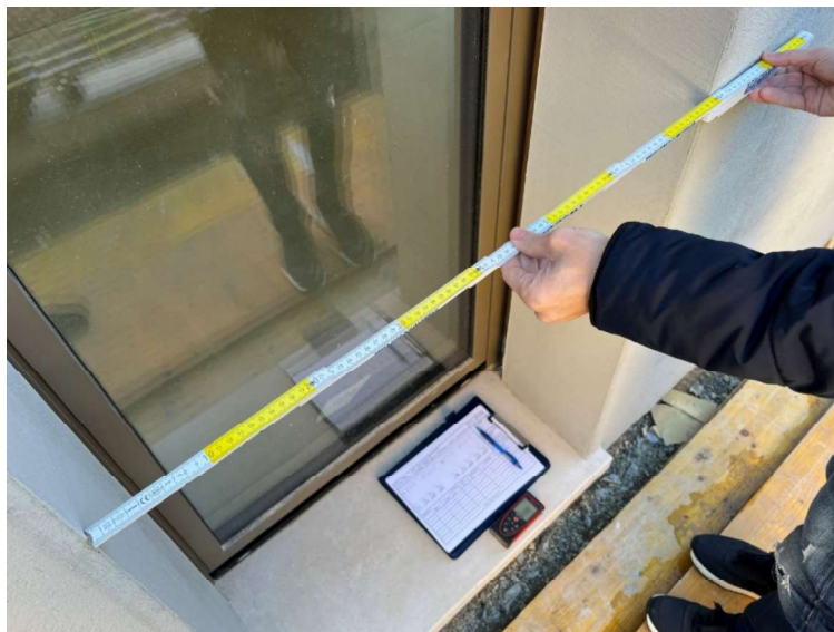
Esempio di rilievo misura architettonica della LARGHEZZA
